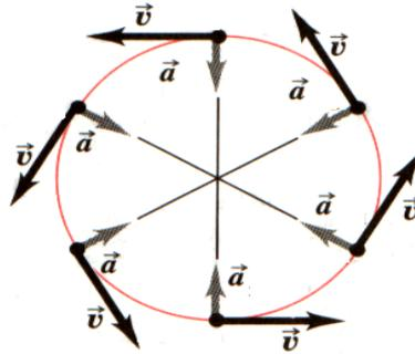
La velocidad tangencial instantánea se puede calcular tomando el límite a la velocidad angular media  $v_T = \lim_{x \rightarrow \infty} \frac{v_2 - v_1}{t_2 - t_1}$
