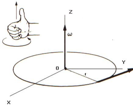
Si la velocidad angular instantánea de un móvil cambia de  $\omega_1$  a  $\omega_2$  en el intervalo de tiempo  $\Delta t$ , el móvil tiene una aceleración angular.
