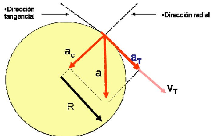
En el **movimiento circular uniformemente acelerado** (MCUA) la aceleración angular es de magnitud constante y su grafica se observa en la figura
