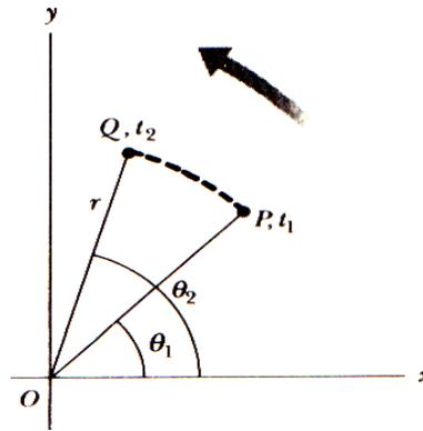
La velocidad angular  $\omega$  es un vector perpendicular al plano del movimiento, representado en el eje del movimiento circular. Por convención el sentido de  $\omega$  se determina por la regla de la mano derecha, los cuatro dedos siguen el sentido de giro de la partícula y el dedo pulgar indica el sentido de  $\omega$ .
